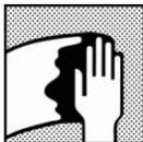
Nettoyer la surface; essuyer toutes traces de poussières en utilisant le M700 (Anti Static Degreaser) ou M200.
