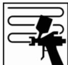
Appliquer une couche moyenne, suivie d'un temps de flash off de 3 à 5 minutes à 20°C
