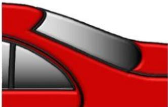
Poncer la zone de raccord et la zone transition vers l'ancienne peinture intacte avec, par ex, 3M Trizact P3000 Disque de finition fin ou similaire.
