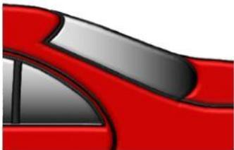
Poncez la zone de raccord et la zone de transition vers l'ancienne peinture intacte avec, par ex. 3M Trizact P3000 Fin Disque de Finition Fin ou similaire.
