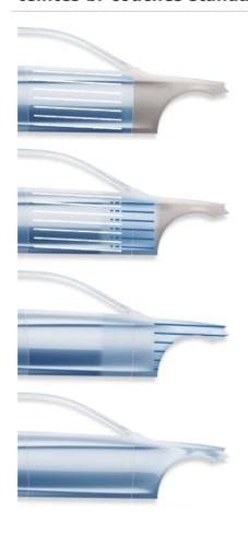
Appliquer Standoblue Color Blend / Color Blend Slow\* sur la zone de transition voisine ou sur les éléments adjacents en fines couches fermées.
