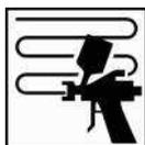
Appliquer une couche sur la partie ponçée. Ensuite appliquer la 2<sup>ème</sup> et 3<sup>ème</sup> couche au dessus de la précédente. Pour une application sur un element entier, appliquer 2-3 couches sur la totalité de la surface en fonction de l'épaisseur du film.
