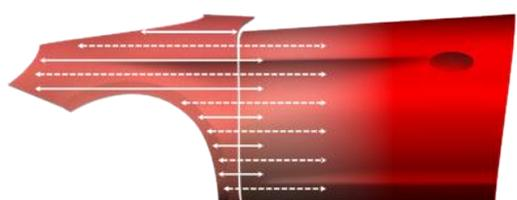
Raccorder la Base mate Standox utilisée. Suivre les instructions de la Fiche Technique de la Base mate Standox respective pour le procédé de raccord recommandé. Laisser désolvater ou sécher la Base mate conformément à la FT.
