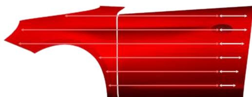
Une autre couche de vernis non teinté sur toute la zone de réparation est recommandée pour simplifier les travaux de polissage ultérieurs. Des ajustements de produit plus lents, des temps de désolvatation et de séchage plus longs doivent être envisagés. Sécher le vernis selon la fiche technique. Pour améliorer l'aspect final de la couche de finition, cette étape peut également être effectuée après un ponçage intermédiaire au P1000.
