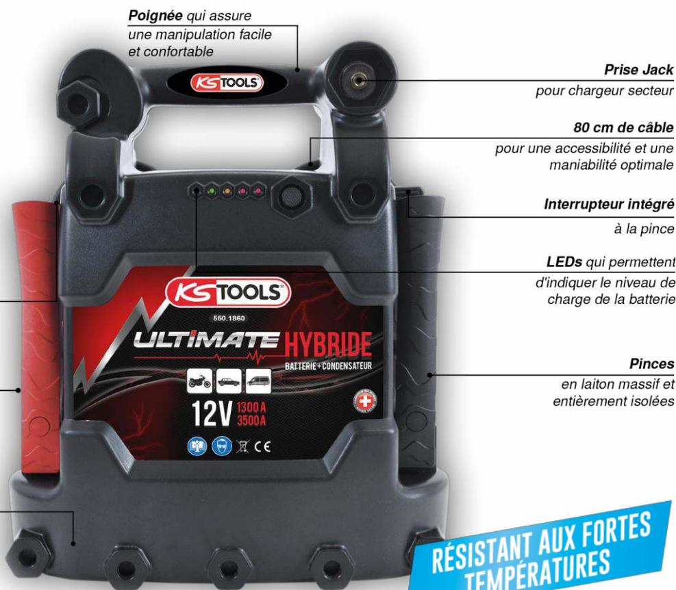
Le booster utilise en priorité le condensateur de 600 FARAD et peut ainsi fournir un courant de pointe de 3500A. La technologie hybride permet de solliciter plus longtemps l'aide au démarrage, par l'intermédiaire de la batterie de 14 Ah.
