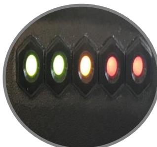
**LEDs qui permettent d'indiquer le niveau de charge de la batterie**
