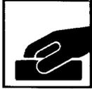
**Le DP4000 peut être appliqué sur une large gamme de supports dégraissés au tampon abrasif, dont :**
