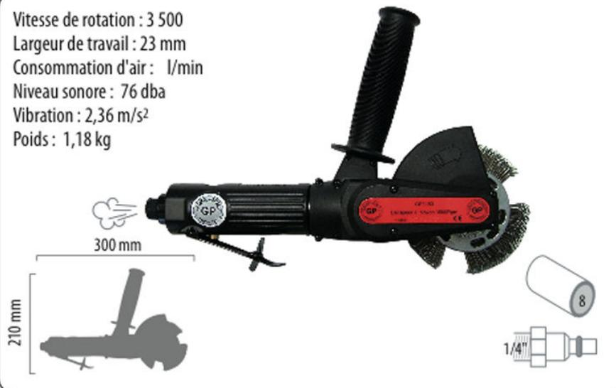
*Travailler en toute sécurité pour les décapages. Indispensable en carrosserie, et dans l'industrie pour le décapage de rouille ou des protections de surface. Maniable, elle offre la possibilité de changer la poignée dans 3 positions différentes. Livrée avec une brosse d'une largeur de 23 mm. Info : 2 largeurs de brosses, 11, 23 mm dures ou souples. Equipée d'une roue gomme crantée, elle permet d'enlever les autocollants sans abîmer les peintures.*
