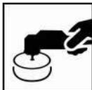
La poussière et les dégâts mineurs peuvent être polis après étuvage et séchage complet suivant les indications données ci-dessus, suivi d'un refroidissement de l'élément à température ambiante. Poncer soigneusement les particules de poussière et restaurer la surface selon les recommandation de ponçage.
